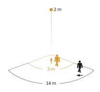
Hauteur d'instal lation: 1,80 m - 3,00 m Orange: sens de passage radial Noir: sens de passage tangentiel
